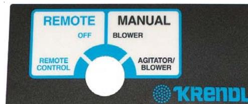
Indique si la machine est en mode à distance, en mode manuel ou éteinte. En mode manuel, ce commutateur fait démarrer la machine. En mode à distance, l'interrupteur à gland commande la machine. À chaque démarrage de la machine, un signal sonore prévient l'opérateur à l'avance.
